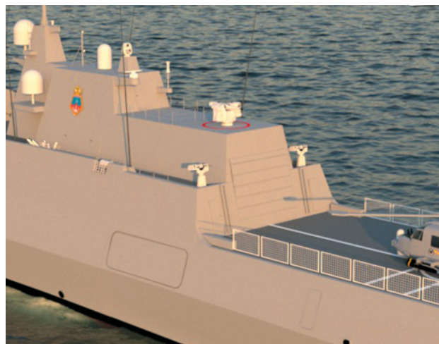
Figura 5. Canhão Sea Snake e Metralhadoras Sea Defender Fonte: http://www.norb3d.com .
