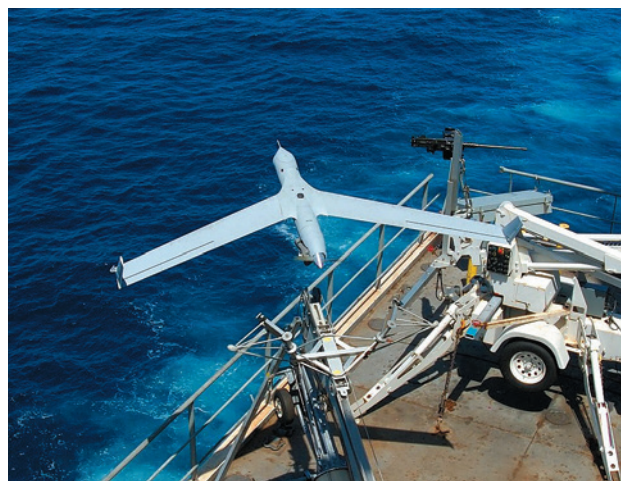
Figura 11. ScanEagle sendo lançado a partir de um meio naval
