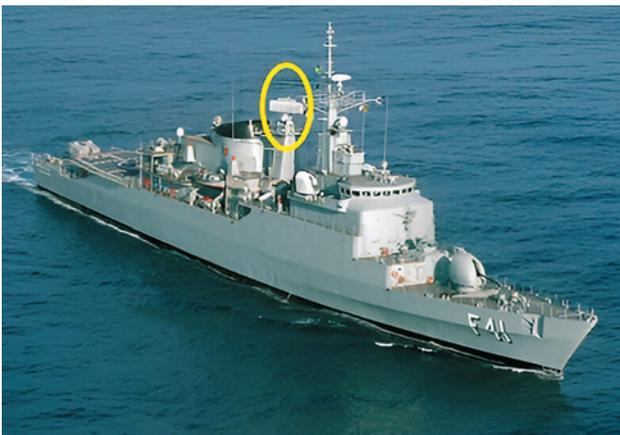
Figura 2. Radar RAN-20S instalado na Fragata Defensora
