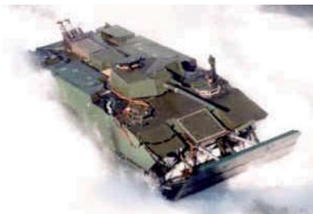
*O AAV possui velocidade na água que varia de 40km/h a 70km/h, dando nova dimensão ao movimento do navio para terra e à mobilidade e proteção blindada para as tropas.*
