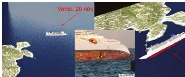
Figura 3 - Deriva do navio com o vento e corrente e o encalhe na ilha de Giglio
