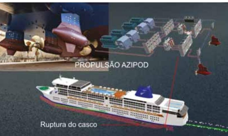
Figura 4 - Esquema da avaria no sistema de propulsão azipod e no sistema de geração de energia a bordo
