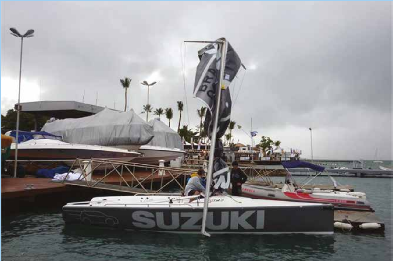
“HPE 25” com o mastro quebrado
