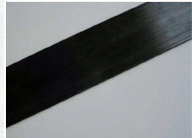
Figura 3 - Chapa pultrudada de fibra de carbono.
