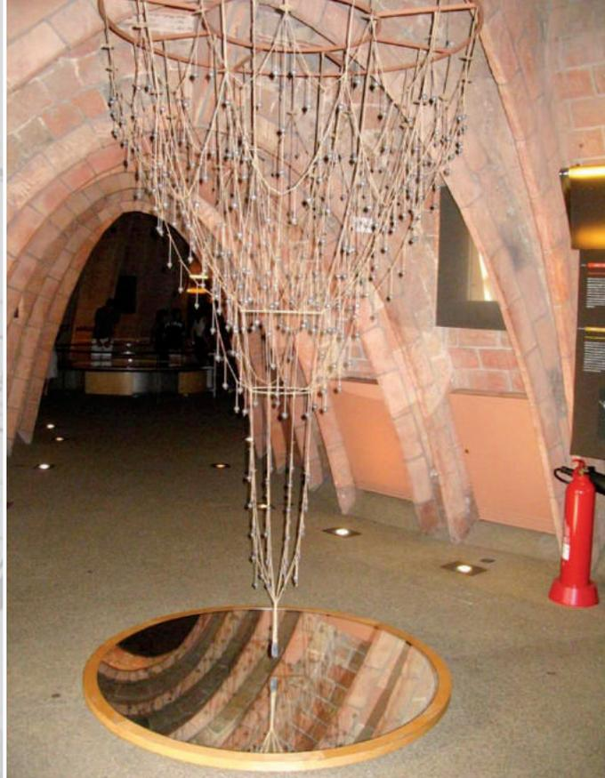
Figura 3 - Reprodução de um modelo suspenso, método adotado por Antoni Gaudí.
