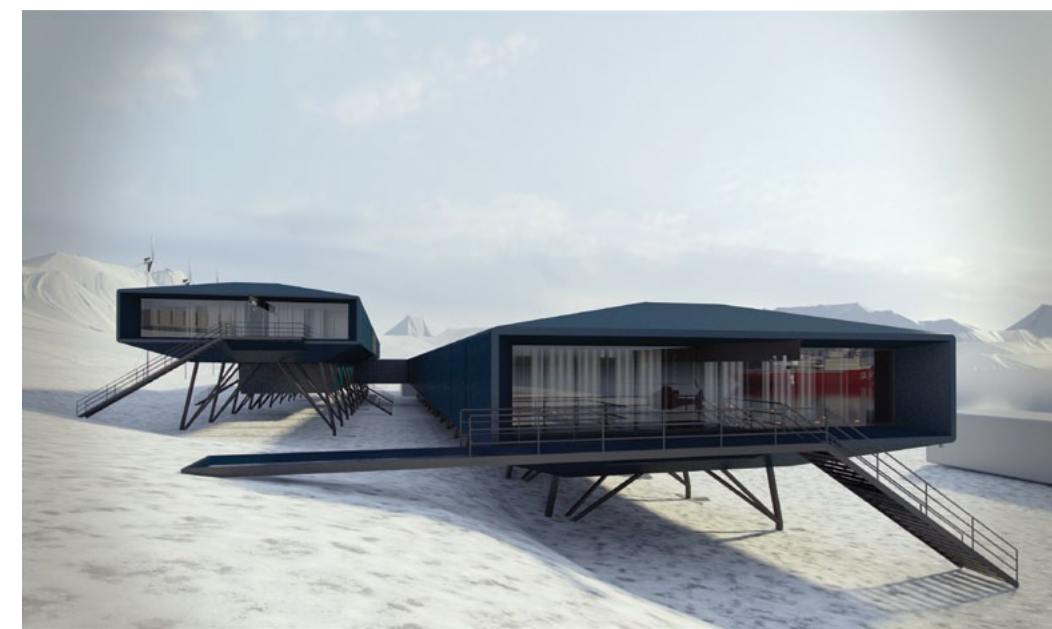
A implantação foi organizada em blocos que distribuem os usos, sendo o bloco superior destinado às atividades privativas e sociais – tais como camarotes e salas de estar, – enquanto o bloco inferior concentra as zonas de laboratórios (ala Sul) e o setor de operação/manutenção (ala Norte). Fonte da imagem: Estúdio 41
